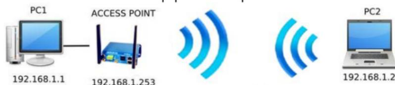
Paramétrez la connexion sans fil du PC2 selon les paramètres d'usine fixés dans le point d'accès (802.11gn, SSID "acksys", pas de sécurité, IP statique 192.168.1.253/24).
